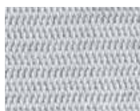
Tkanina o splotie jodełki (GK) Równomiernie rozmieszczone kieszenie powietrzne
