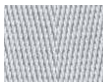
Splot ukośny (K) Rowki powietrzne o profilu „rybia ość”
